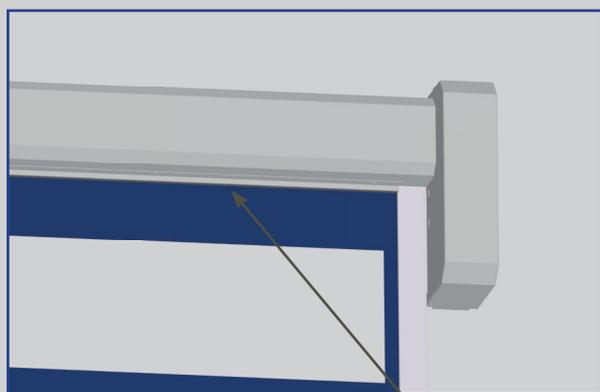
Antrieb und Ballenverkleidung mit Dichtlippe
